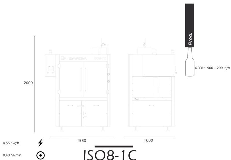
Macchina con riempimento isobarico a 8 rubinetti, completa di comandi pneumatici delle varie fasi.
